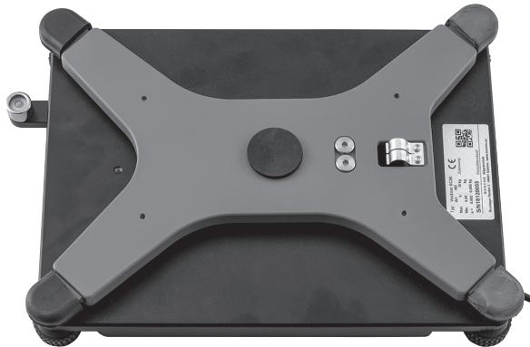
Abb. 2: Libelle neben dem Gehäuse der Vectron SC25/SC50 montiert
